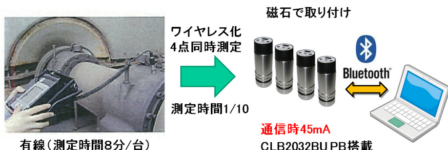
Fig. 5 採用事例 無線式ポータブル振動診断計
