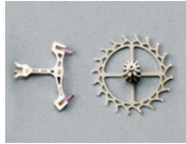
図 7 UV-LIGA プロセスで作製されたがんぎ車とアンクル グランドセイコー 9S ムーブメント 8)
