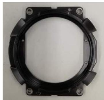
Fig. 5 Stainless steel bezel antenna.
