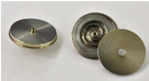
図 1 香箱車(左)と蓋を外した状態の香箱車(右)
