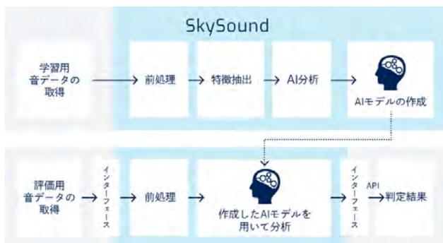
図 1 異音検査 SkySound の学習の流れ<sup>1)</sup>
