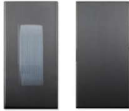
図5 耐傷性試験後の外観比較 3) を表面のビッカース硬さ (左: 一般的な黒色膜 右: DLC) が 1,000HV 以上としている。
