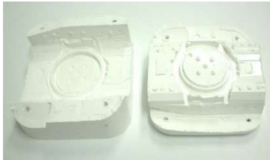
図6 時計外装用 CFRP 成形シリコンゴム型 9)
