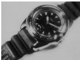
図 15 ポータブル超塑性加工装置で超塑性鍛造して得られた SP700 時計外装 9)
