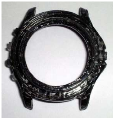
図7 シリコンゴム型成形 CFRP 製ケース 9)
