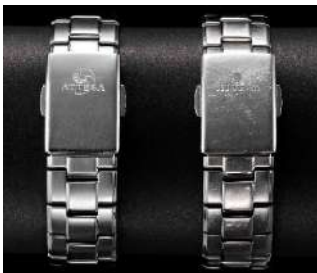
図 10 携帯試験による耐傷性比較 ③ (左：未処理品 右：表面硬化処理品)
