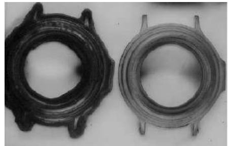
図 13 超塑性鍛造した SP700 ブランク(左)とショットピーニング処理後(右) 5)
