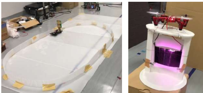
図 5 玩具自動車, 玩具ドローンの光無線給電による移動中給電
